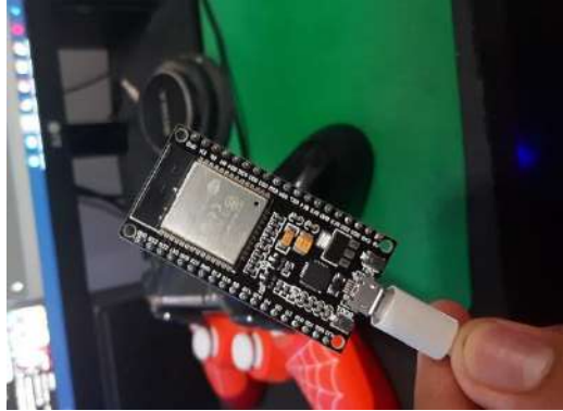
Figura 33 Conexión del módulo ESP32 hacia el pc
