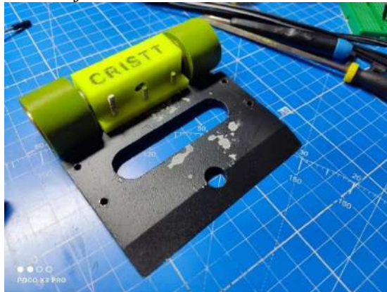
Figura 29 Montaje de los motores con el chasis
