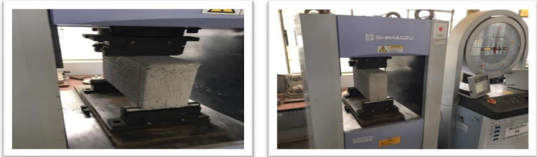
Figura 15. Colocación de apoyos para ensayo
