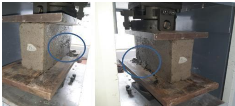
Figura 11. Deformación de probetas con 40% de PET ante esfuerzos de compresión
