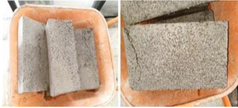
Figura 12. Probetas ya sometidas al ensayo de compresión
