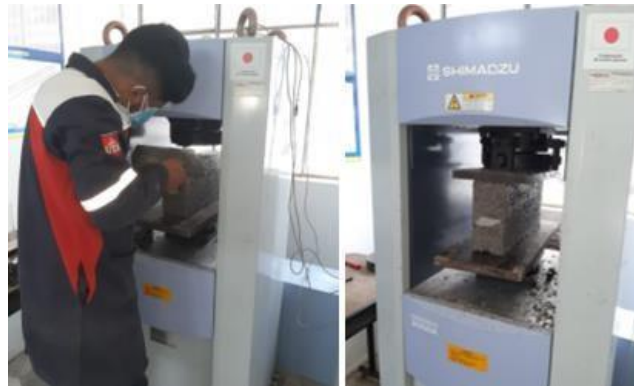
Figura 10. Aplicación de carga máxima a las probetas
