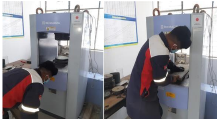
Figura 8. Colocación de alzas y placas de apoyo
