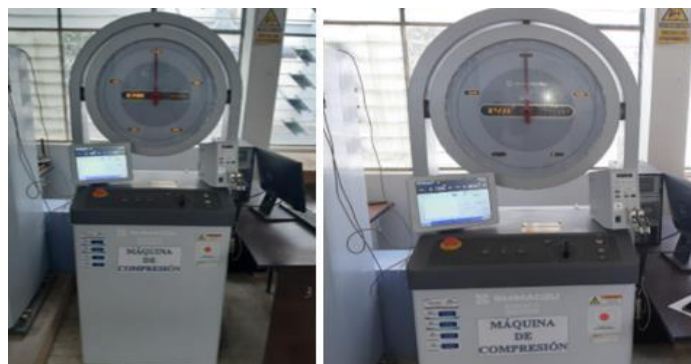
Figura 9. Encendido de máquina de compresión modelo SHIMADZU
