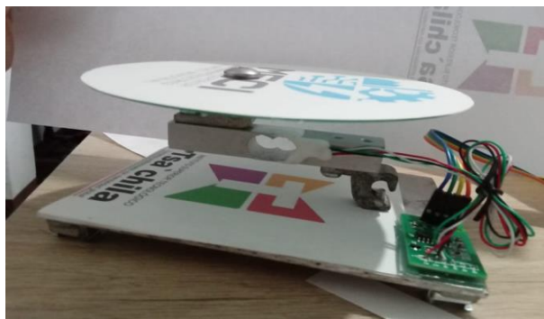
Figura 10 Celda de carga totalmente implementada
