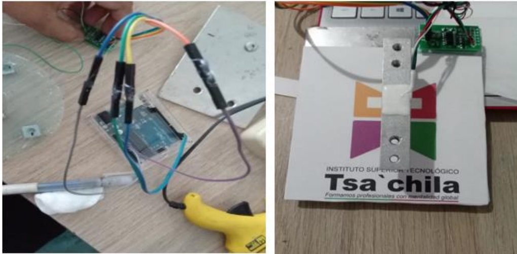
Figura 9 Conexión de transductor HX711 con la celda de carga y arduino
